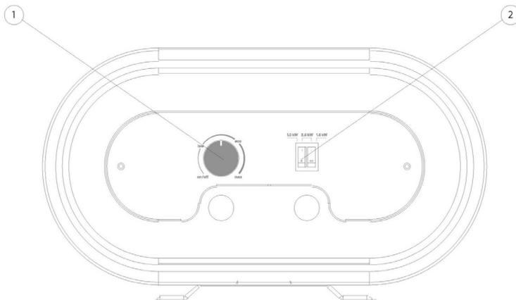
Рисунок 3: 1 – механический регулятор температуры, 2 – клавиши выбора мощности. Индикатором режима работы ЭВН служат лампы подсветки клавиш выбора мощности, они светятся при нагревании воды и гаснут при достижении установленной термостатом температуры нагрева воды.
