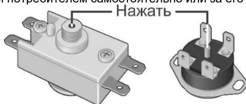
Рисунок 5. Возможные схемы расположения кнопки термовыключателя
