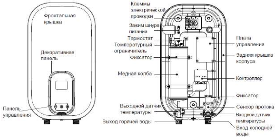
Рис.6 Составные части ПЭВН
