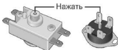
Рисунок 3. Возможные схемы расположения кнопки термовыключателя
