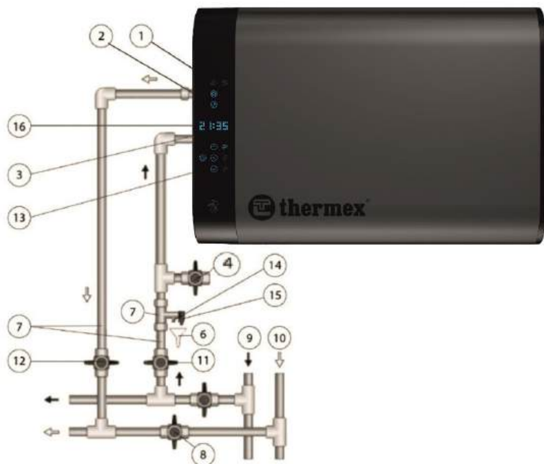
Рисунок 2. Схема подключения ЭВН к водопроводу в горизонтальном положении
