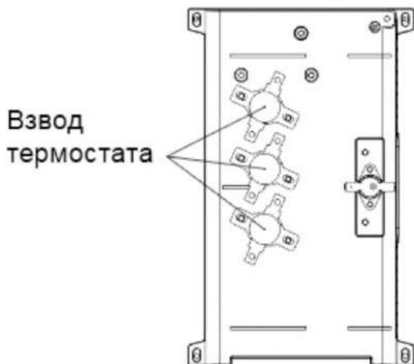
Рис. 20. Ручное восстановление термостатов
