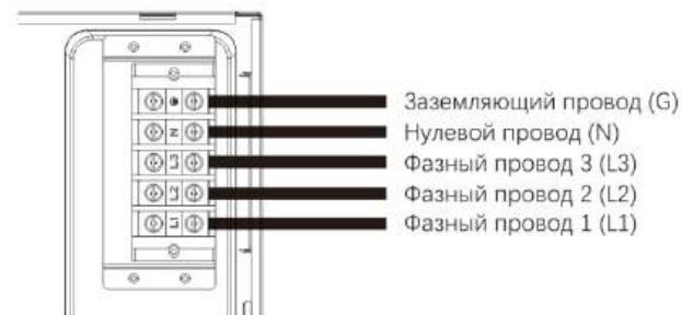
Рис 14. Трехфазное подключение прибора
