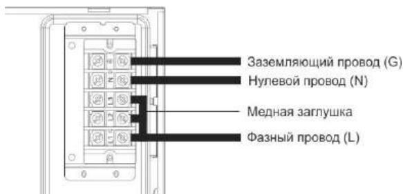
Рис 13. Однофазное подключение прибора
