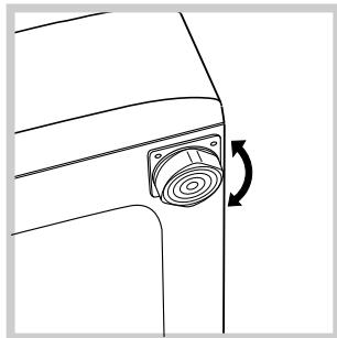
2. После установки машины на место отрегулируйте ее устойчивое положение путем вращения передних ножек (см. рис.). Для этого сначала ослабьте контргайку, после завершения регулировки контргайку затяните. После установки машины на место проверьте по уровню горизонтальность верхней крышки корпуса, отклонение горизонтали должно быть не более 2°.
