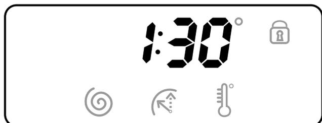
При нажатии кнопки ПУСК/СБРОС (Start/Reset) для запуска программы на дисплее показывается приблизительное время, остающееся до завершения цикла. В случае установки отложенного старта программы (Таймер отсрочки, см. с. 7) дисплей будет показывать время, оставшееся до начала стирки.
