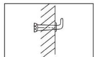
**При наличии двух или трёх кронштейнов крепления, крепление водонагревателя за один из нескольких предусмотренных кронштейнов не допускается.**
