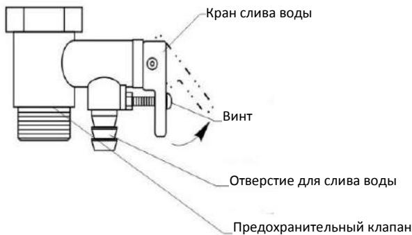
**Внимание! Между входным патрубком водонагревателя и предохранительным клапаном должно обеспечиваться соединение с постоянным полным проходом. Установка запорной арматуры (краны, вентили и т.п.) на этом участке не допускается!**
