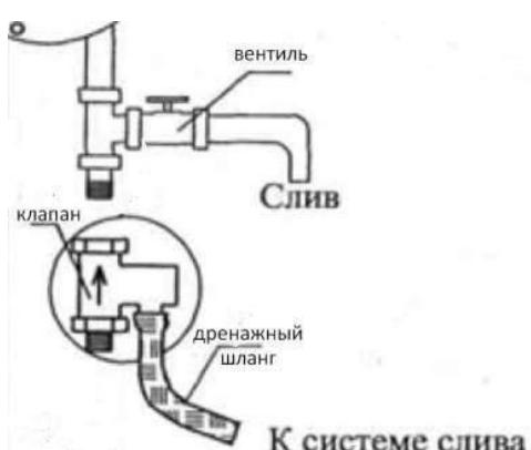
Во избежание поломки при завинчивании предохранительного клапана не применяйте больших усилий.
