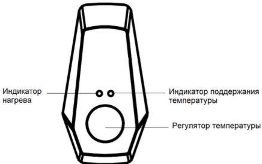
При достижении заданной температуры встроенный термостат автоматически отключает нагревательный элемент, и индикатор нагрева гаснет. Теперь водонагреватель находится в режиме поддержания температуры. Загорается индикатор поддержания температуры.
