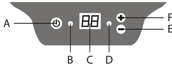
А — Кнопка включения / выключения водонагревателя.
