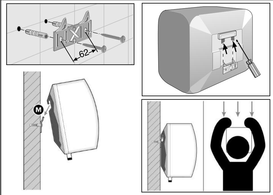
**Schema installazione - Installation scheme - Schéma d'installation - Installatieschema - Installationsschema - Esquema de instalación**
