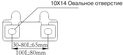
Вставьте пластиковые дюбели в отверстия. Далее с помощью винтов, вставленных в дюбели, закрепите ответные планки к стене.
