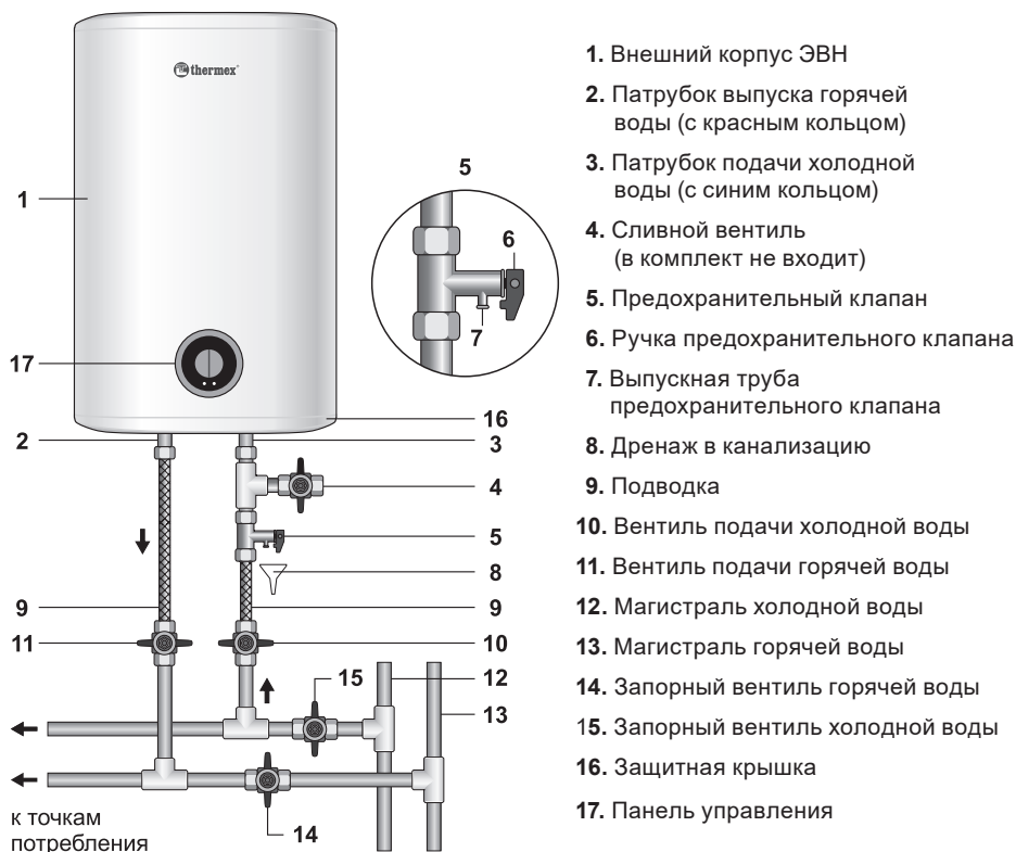
Рисунок 2. Схема подключения ЭВН к водопроводу.
