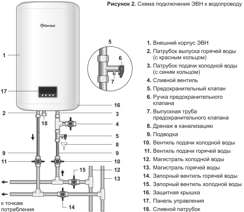
Рисунок 2. Схема подключения ЭВН к водопроводу
